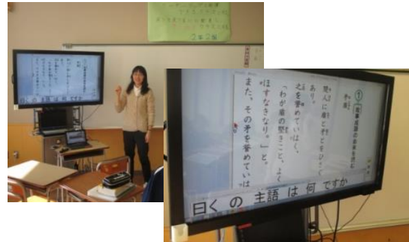
こえみる(音声文字化システム)を活用したわかりやすい授業 中学部「国語」 マイクを通し、話したことがモニターに文字化されるシステム
